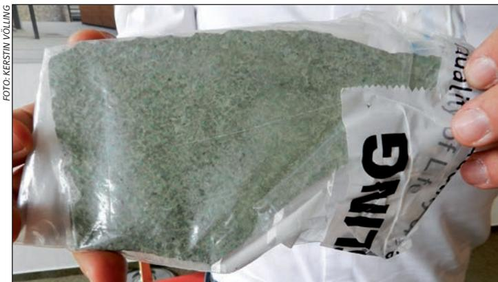
Mit dem bloßen Auge nicht erkennbar: Bauamtsleiter Sven Noetzel zeigt eine Sandwichplatte mit Isolierschicht. Wahrnehmbar ist nur der Kleber (grün schimmernde Brösel), unter der sich die Isolierschicht befindet. Bei den Platten im Bauabschnitt I fehlte diese Schicht.
