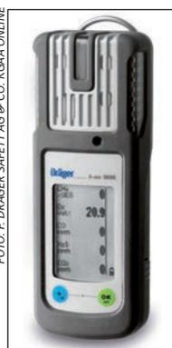
Mess- und Anzeigegerät für Feuerwehren zur Detektion von Gasen
