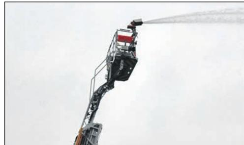
Den Werfer am Drehleiterkorb. Um ihn nutzen zu können, sind ein Löschfahrzeug mit entsprechender Pumpenleistung und eine ausreichende Wasserversorgung erforderlich. Dabei bilden die beiden Fahrzeuge eine Einheit.
