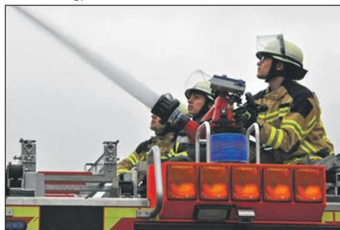
Betrieb des Dachwerfers des Löschfahrzeugs
