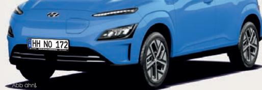
100 (136) kW (PS) // 1-stufiges Reduktionsgetriebe
