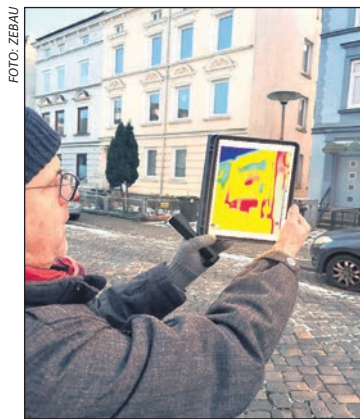
Infrarotaufnahme eines Hauses im Rahmen einer Sanierungsberatung werden Empfehlungen vorgestellt, wie sich Wärmeverluste über Fens-
