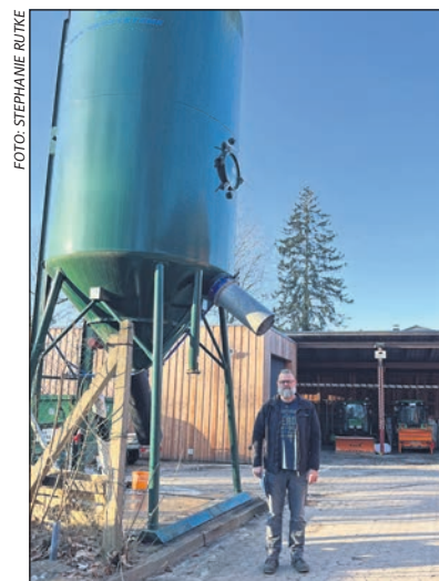
Hagen Hartmann, Leiter des gemeinsamen Bauhofes der Gemeinden Aumühle und Wohltorf, vor dem Silo, der 26 Tonnen Streusalz fasst.
